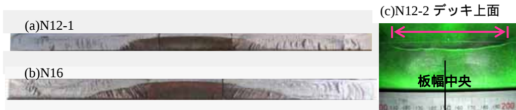
写真 1 疲労破面と上面き裂
