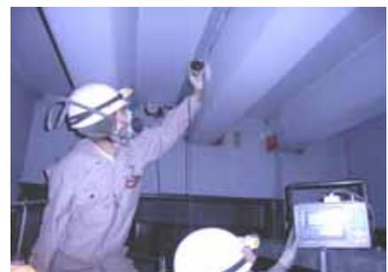
図5 き裂探傷状況
