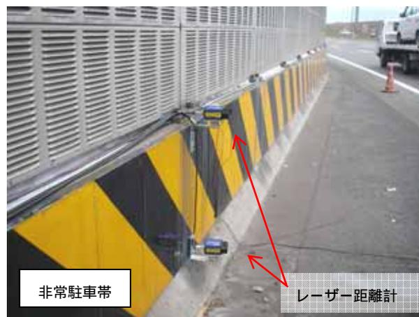
図-1 高欄に設置したレーザー距離計
