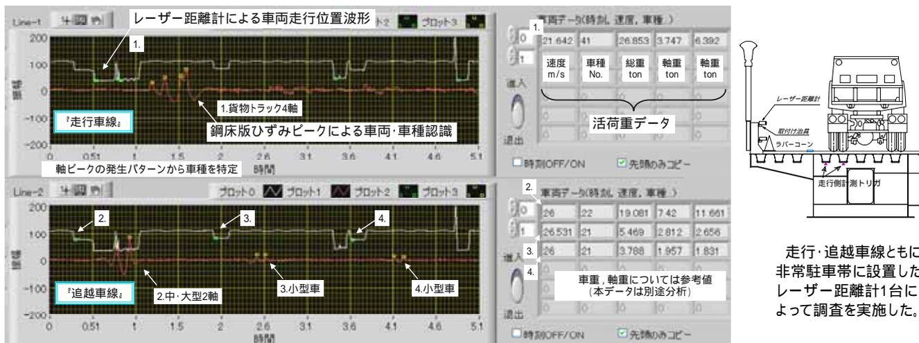
図-2 レーザー距離計・鋼床版Uリブの出力波形と分析状況
