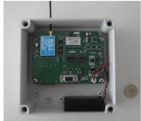
図 1 開発したセンサノード
