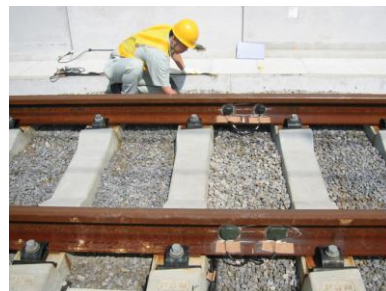
写真1. 輪重測定のゲージ状況
