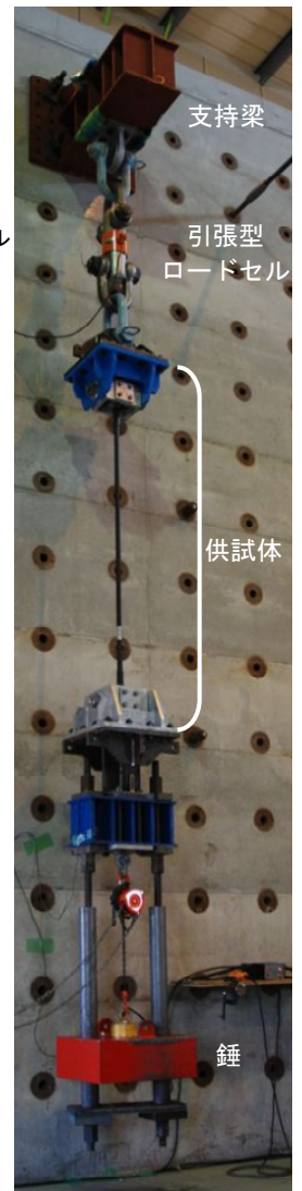
写真-1 衝撃実験装置の設置状況
