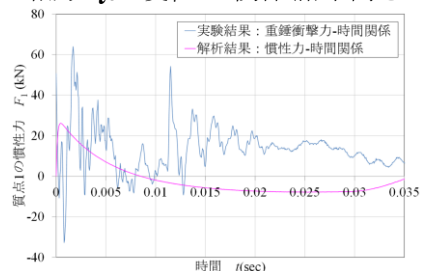
図-9 慣性力 F_1 —時間 t 関係(落下高さ 8cm)
