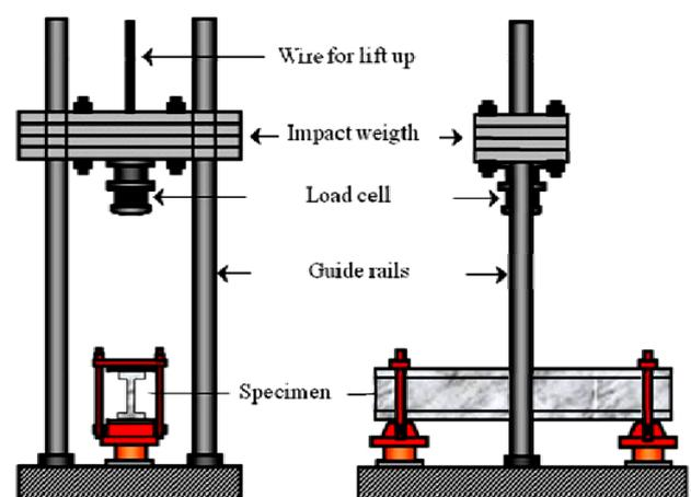
Fig. 2 Experimental apparatus
