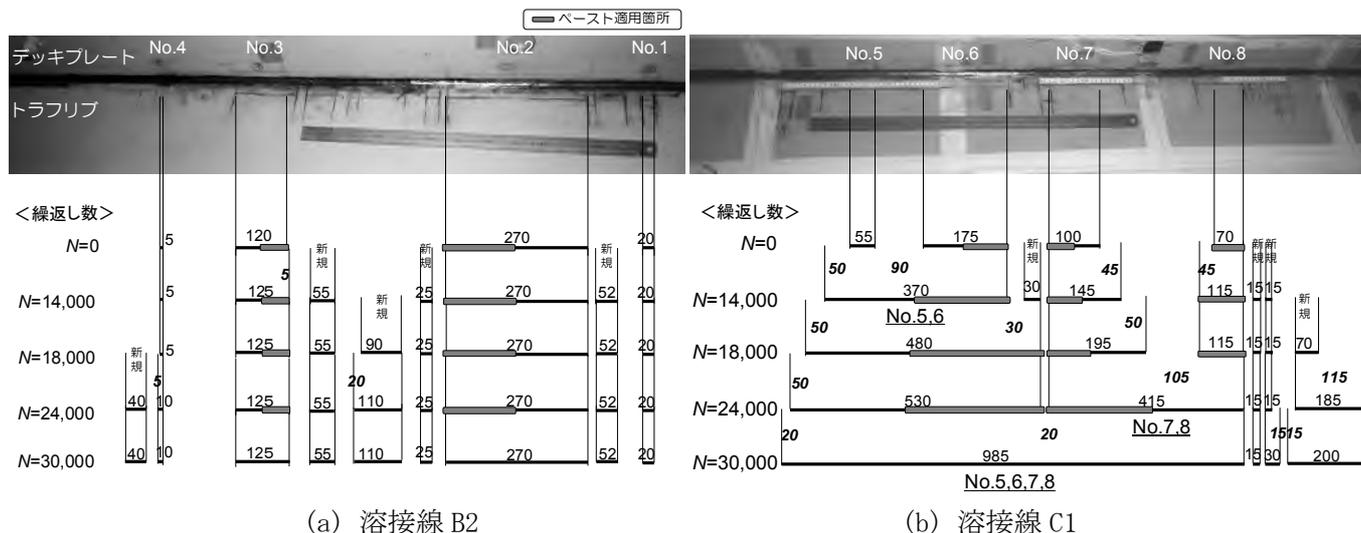
図2 デッキプレートとトラフリブ間の溶接止端部に発生した疲労き裂の進展推移
