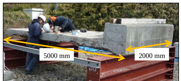
写真-1 床版供試体の外観
