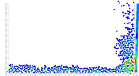
図-5 ダムブレイクの解析例
