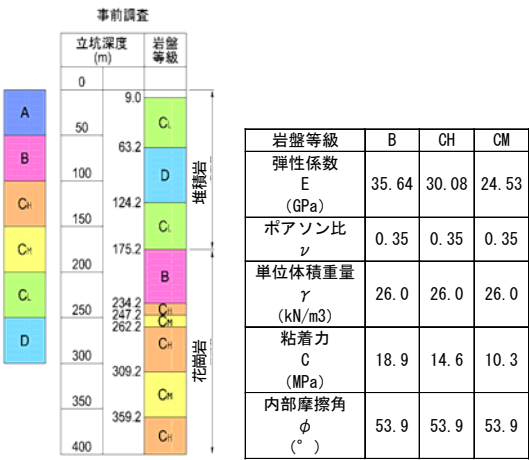
図-1 当初設計時の地層構成と力学定数
