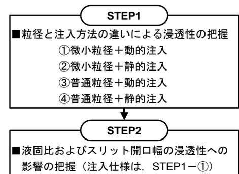
図 2 動的注入試験のフロー
