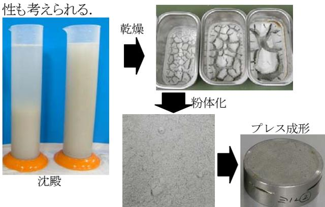
図6 NaCl 含有緩衝材の透水試験供試体作成手順
