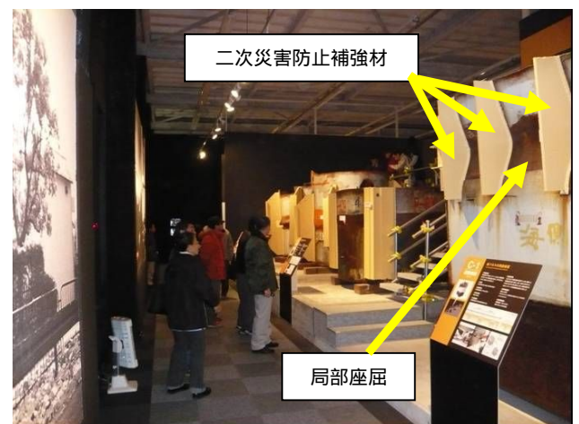
図-5 震災資料保管庫一般公開の様子 (鋼製橋脚の損傷と緊急対策)
