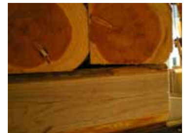
写真3 終局時のラグスクリーンの引き抜け
