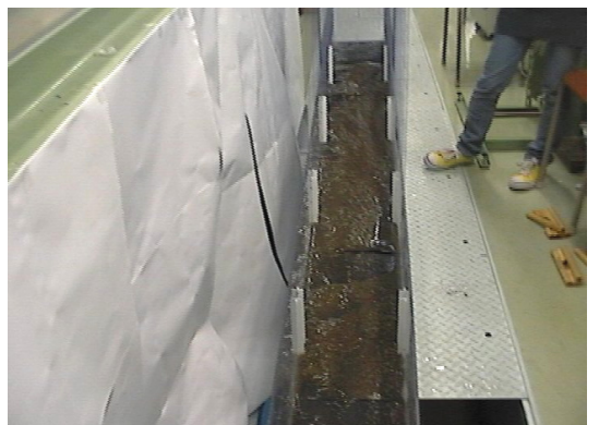
写真-3 隔壁撤去後の土砂の残留 (Case-4)
