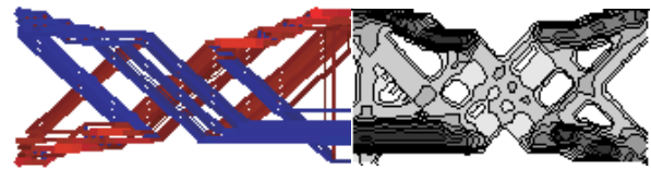
図1 位相最適化による骨格形態形成の解析結果(20×80分割)
