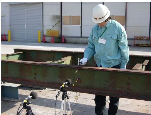
写真 2. 衝撃試験状況
