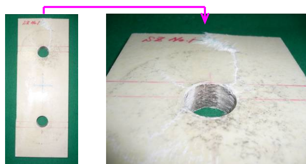
写真-3 支圧破壊の状況 (No. 1 試験片)
