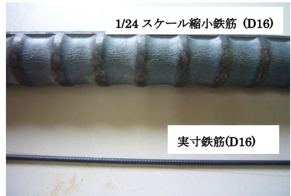
写真2 実寸鉄筋と縮小鉄筋の比較
