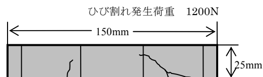
図-6 1/12 スケールせん断破壊
