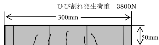
図-3 1/6 スケール曲げ破壊
