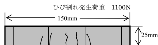
図-5 1/12 スケール曲げ破壊
