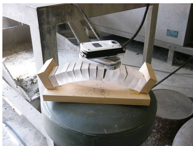
図1. アクリルブロックと砂を用いたアーチ橋模型
