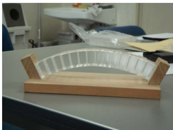
図2. アクリルブロックのみを用いたアーチ橋模型
