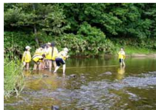
写真-2 朱太川での流れの速さの測定
