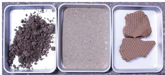
(a)汚染土 (b)洗浄済み土 (c)脱水ケーキ
