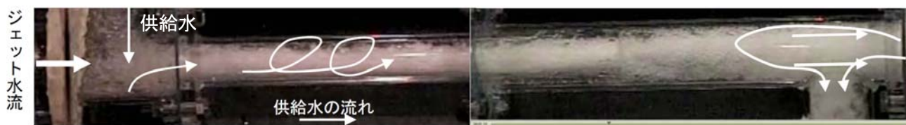
写真-1 アクリル模型による流れの可視化例
