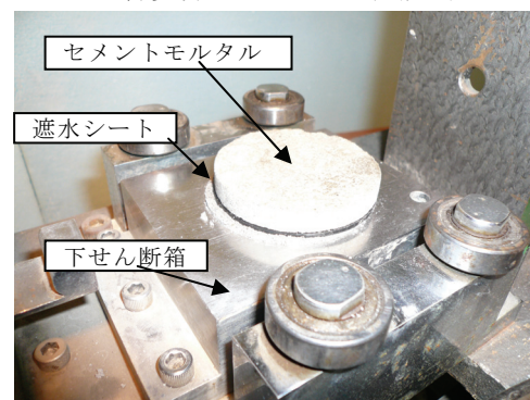
写真-1 せん断試験後の状況
