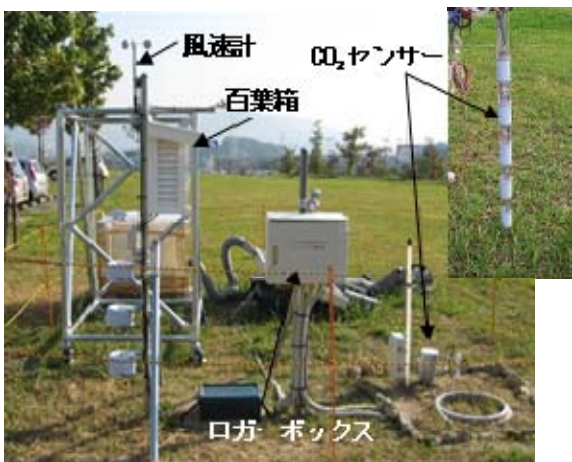
写真-1 測定状況の全景
