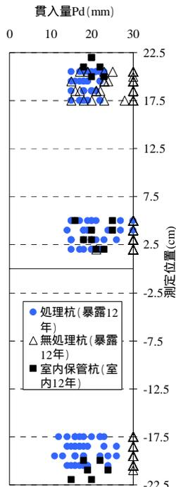
図-3 ピロディン試験結果
