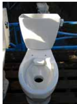
図-3 洗浄水循環型トイレ
