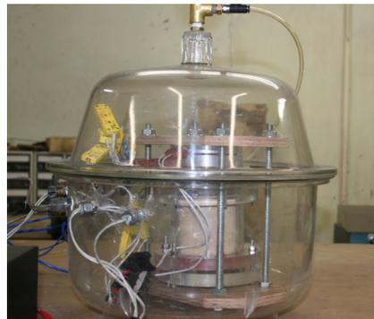
写真1 熱伝導率測定装置
