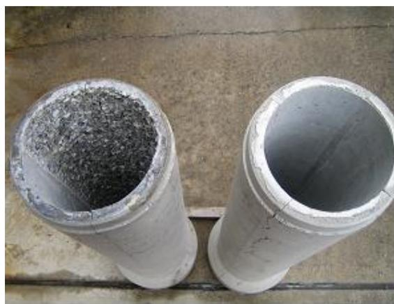
写真-1 暴露試験後のコンクリート管の様子
