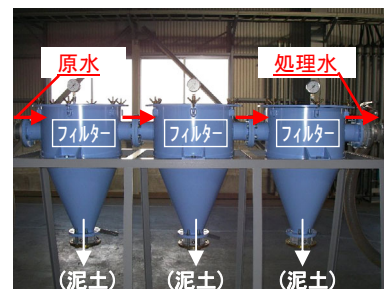
写真-1 濁水処理装置外観
