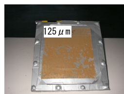
写真-3 フィルター状況 (室内実験/通水後)
