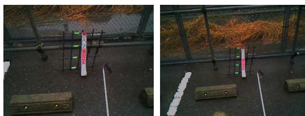
写真 - 1 寸法確認時 本部 PC 画像 (左：離隔 1m、右：離隔 2m)
