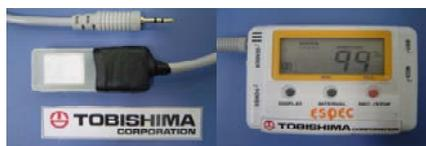
図-2 埋設型相対湿度センサとデータログ
