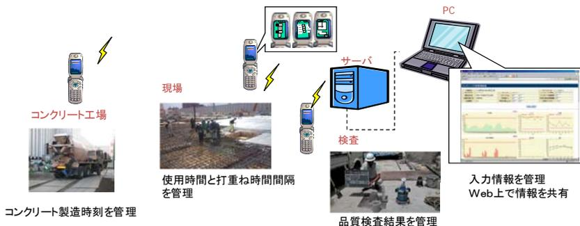
図-1 携帯電話と Web によるコンクリートの打設管理システムの概要
