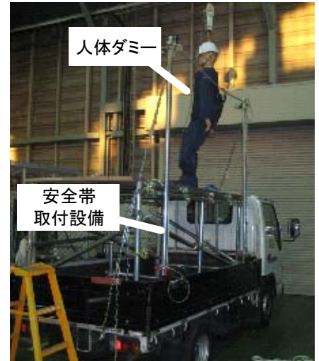
写真1 安全帯取付設備
