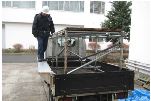
写真4 作業床によるトラック積載型の墜落防止設備
