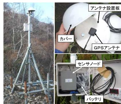
図—2 センサノードの設置方法
