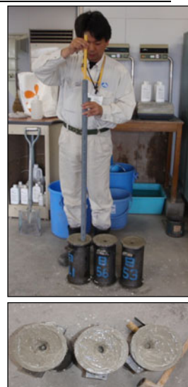
写真-3 N式貫入試験実施状況
