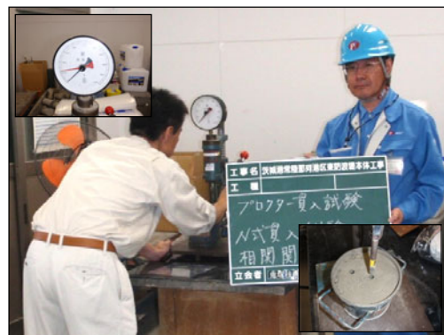
写真-2 プロクター貫入試験実施状況
