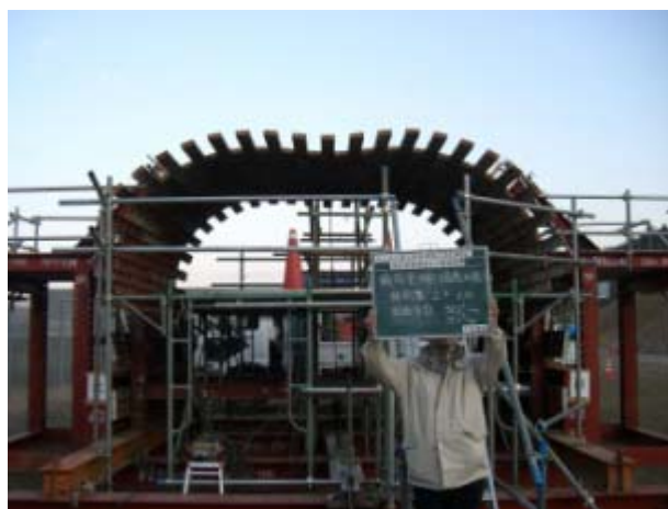
写真-2 メタルフォーム載荷実験状況
