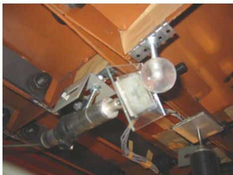
写真-1 引張側変形状況
