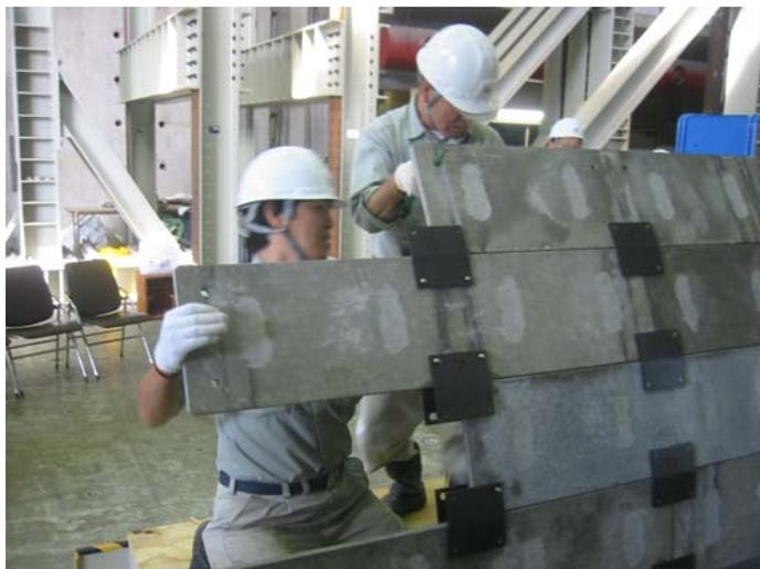
写真-3 ダクタイルパネル組立実験状況
