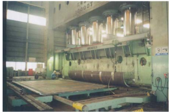
写真-1 板巻鋼管プレス状況
