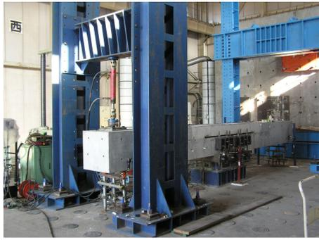
写真-2 実物大載荷試験全景(Type-2)
