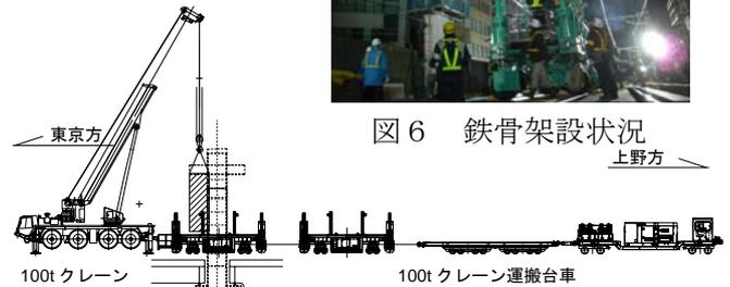
図7 鉄骨架設機械編成(架設中)
