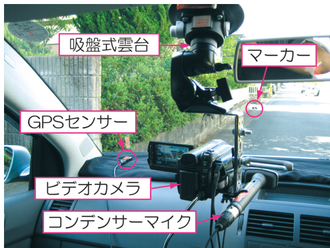
図-1 記録装置の設置状況
