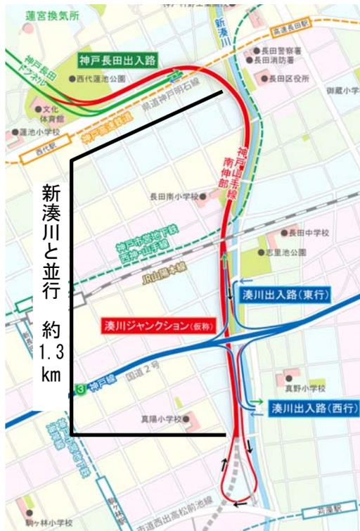
図-1 神戸長田トンネルの新湊川並行区間概要図
