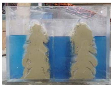
写真-1 仕切壁材水槽打設状況(側面から)
