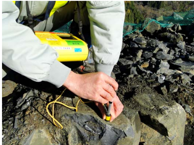
写真—1 エコーチップ硬さ試験測定状況
