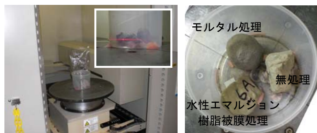
写真-3 X 線 CT 画像の撮影状況
