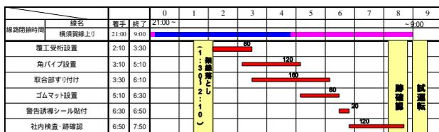
図3 支柱と覆工受桁による仮設ホームのサイクルタイム
