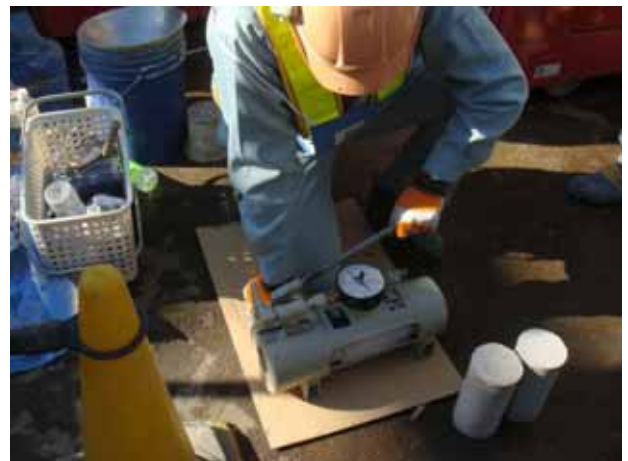
写真-4 圧縮強度試験状況
